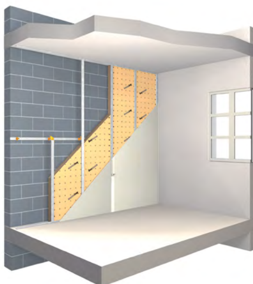
Imagen 2. Instalación sobre perfiles metálicos en horizontal
