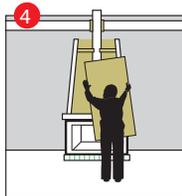
Cerrar los laterales y formar la cámara de recuperación y después la de descompresión con un panel Firerock.
