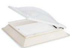
DANOEXIT® (Salida a cubierta) Claraboya practicable con cúpula y valva de metacrilato, con zócalo de poliéster reforzado. Producto para iluminación natural y acceso a cubierta
