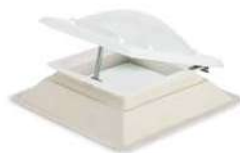
DANOVENT® MANUAL (Ventilación) Claraboya practicable con cúpula y valva de metacrilato, con zócalo de poliéster reforzado. Producto para iluminación natural y ventilación, mediante apertura manual por manivela
