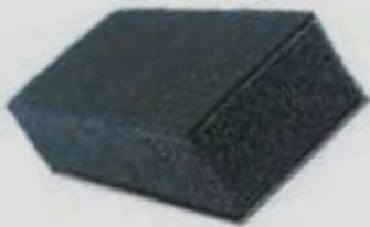
**Composición:** Film de tejido no tejido negro, espuma de poliuretano absorbente ignífuga M-1 y masa pesada visco elástica de 5 kg/m<sup>2</sup>.
